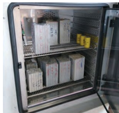
Klimatkammare med prismor för accelererad karbonatisering (Schweizisk SIA 262/1-X standard)
