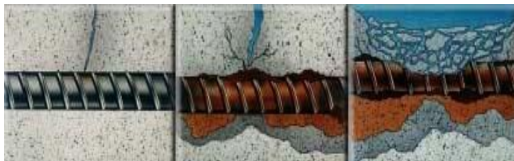
Nedbrytningsförlopp i betong med Armeringskorrosion, Rost- & Frostsprängningar
