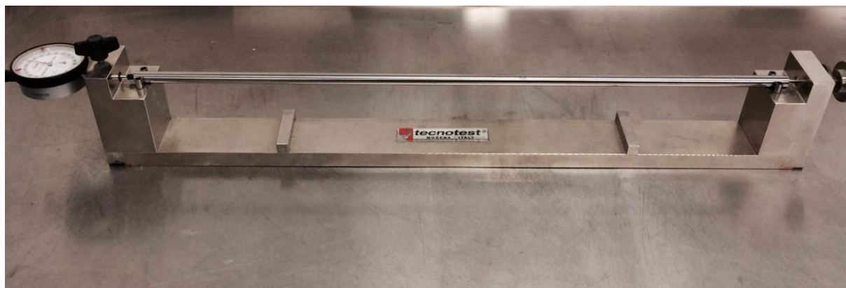
Figur A-1: Lengdemålingsrigg med 500 mm referansestav
