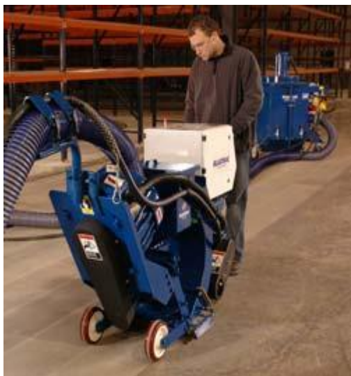
Figur 7-19: Blastring av betongoverflate
