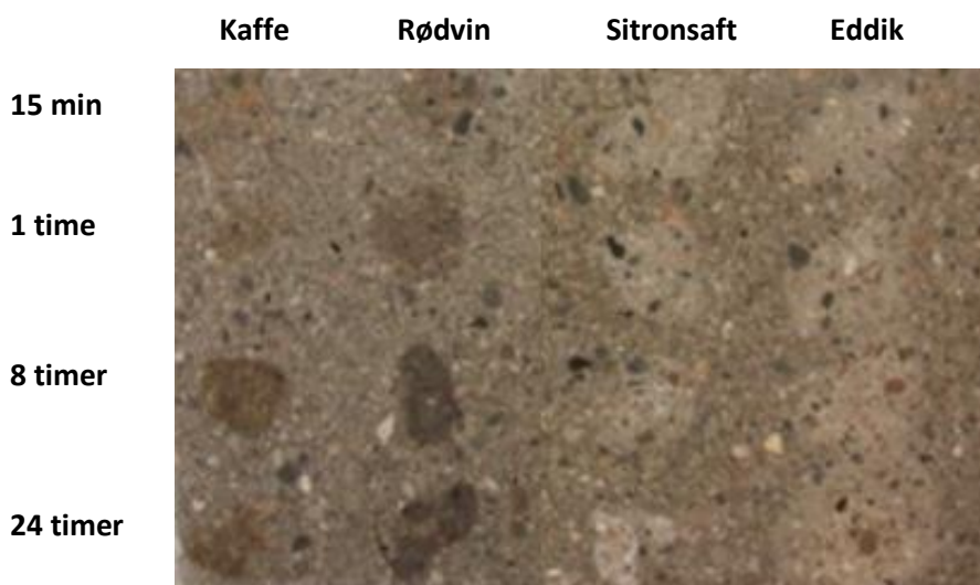
Figur 7-20: Effekt av hydrofoberende impregnering på slipt betongoverflate ved søl med ulike materialer
